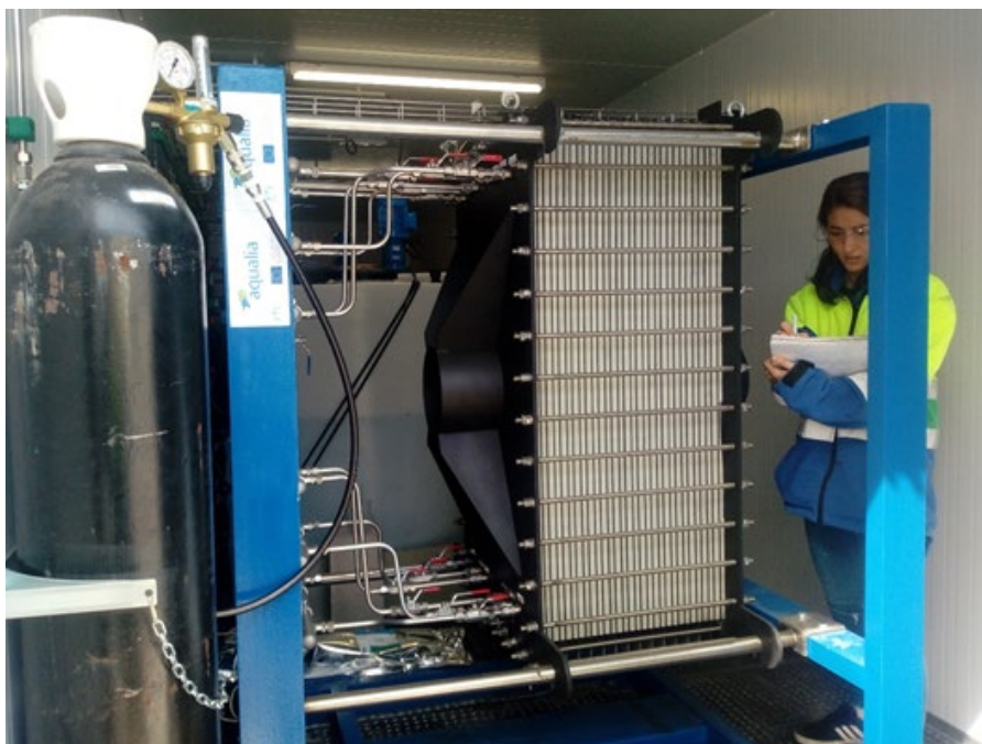
Figura 2. Vista interna de las células MDC dentro de la planta piloto
