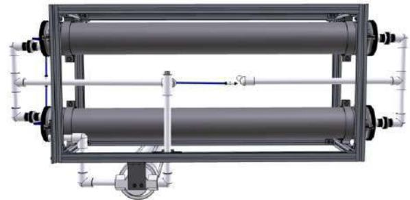
Funciona manteniendo una relación de 1:5 de permeado respecto a la alimentación. El diseño propuesto permite tener una alimentación y dos salidas, una para el agua producto y otra para el rechazo o salmuera, el cual se dirige a un sistema de reinyección. El prototipo está conectado a un sistema fotovoltaico (FV) con una potencia promedio de 1.92 kW, el cual suministra energía a una bomba centrífuga sumergible de corriente directa, sin banco de baterías.
